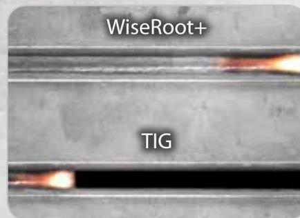
*Процесс WiseRoot+ предлагает в 5 раз больше в выполнении корневых швов, чем процесс TIG. Подложка не требуется, обеспечивается высокое качество, сокращается объем шлифовки и подготовительных работ.*
