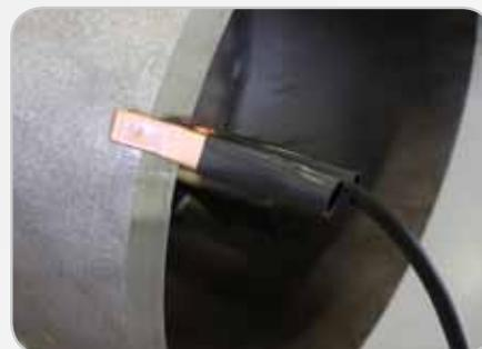
*Кабель потенциального считывания измеряет фактическое напряжение дуги в ходе сварки. Это позволяет процессу WiseRoot+ оптимизировать сварочные характеристики, что гарантирует перенос присадочного материала с минимальным разбрызгиванием и стабильность сварочной дуги.*
