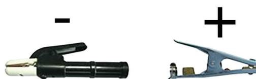
ПОЛОЖЕНИЕ ЭЛЕКТРОДА ПРИ СВАРКЕ
